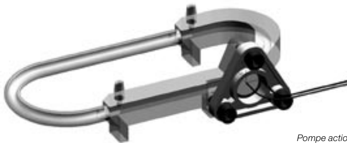
Pompe actionnée par un disque piézo
