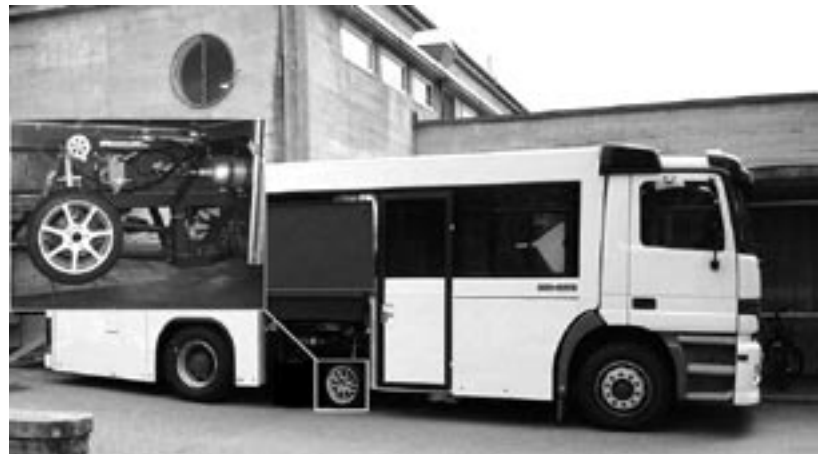
Das mobile Reifenversuchslabor auf LKW-Basis und die Messradanordnung
