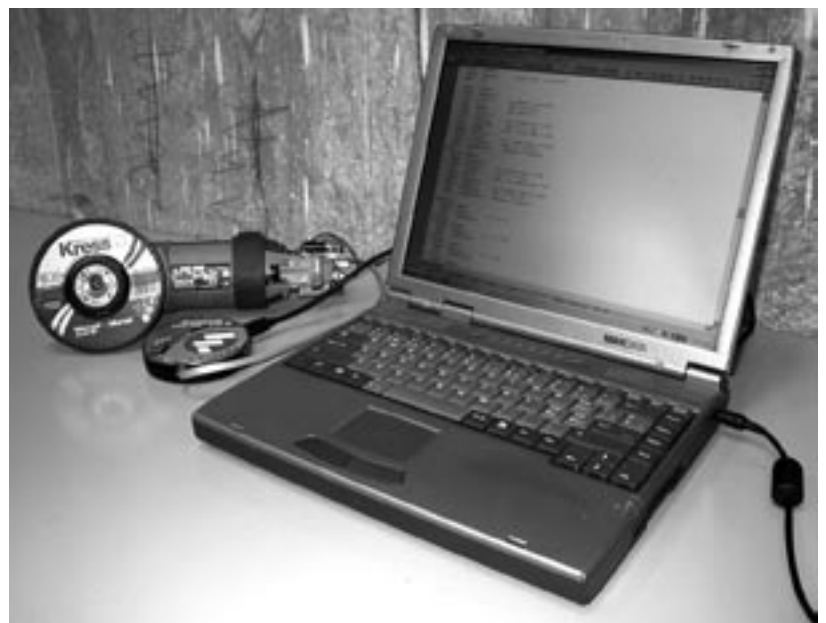
Winkelschleifer mit Regel-Interface und der Entwicklungsumgebung von Microchip
